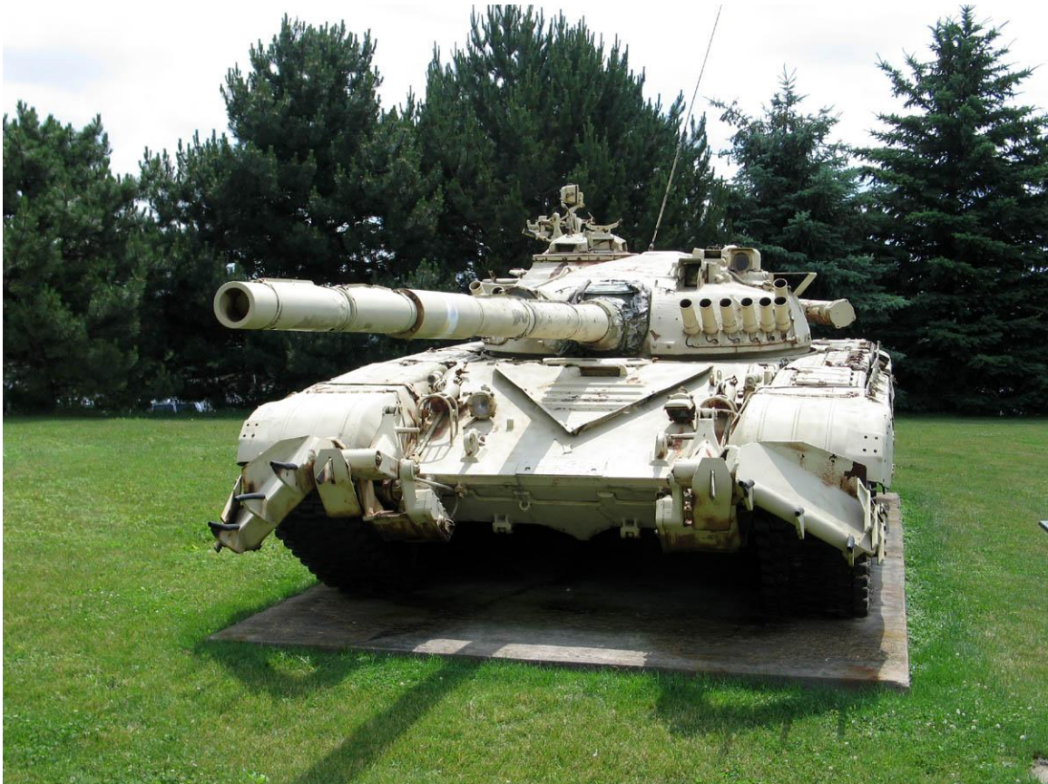
Carro armato di produzione sovietica T-72 ridotto in mostra statica (demilitarizzato), per scopi museali. Il Trattato CFE prevede la rimozione del motore e degli organi di trasmissione, e interventi sulla bocca da fuoco in maniera da precludere ogni spostamento della stessa sui piani sia zenitale sia azimutale.
