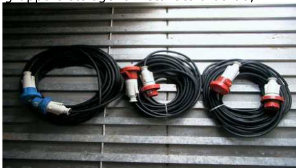
foto n. 19 – Prolunghhe elettriche in dotazione
