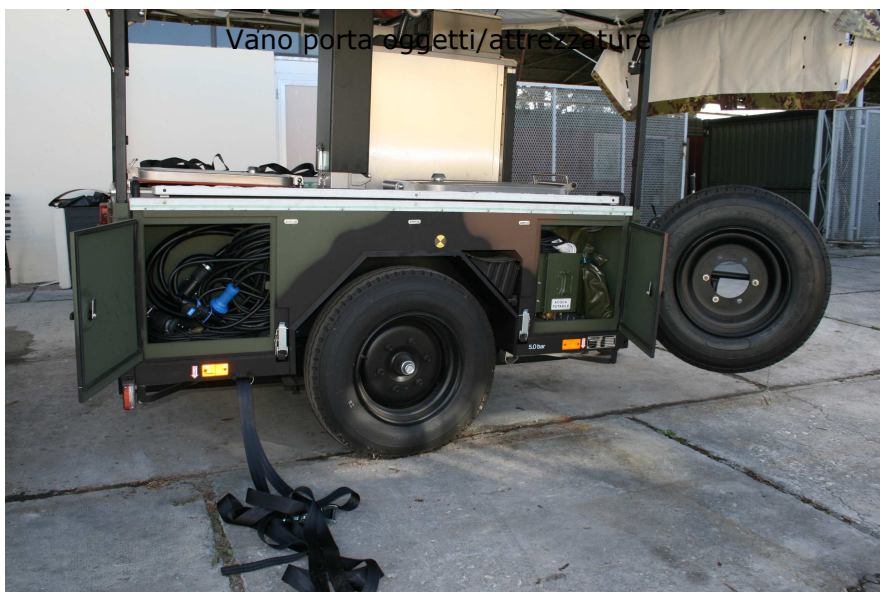
Vano porta cavi elettrici e vano porta taniche
