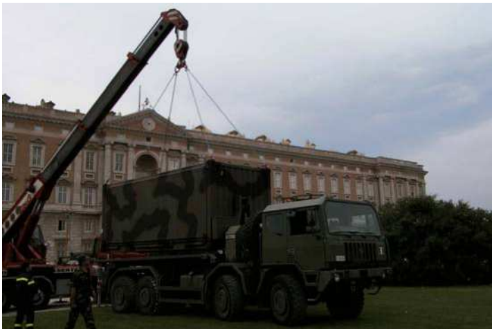
foto n. 2 – Scarramento shelter a mezzo gru
