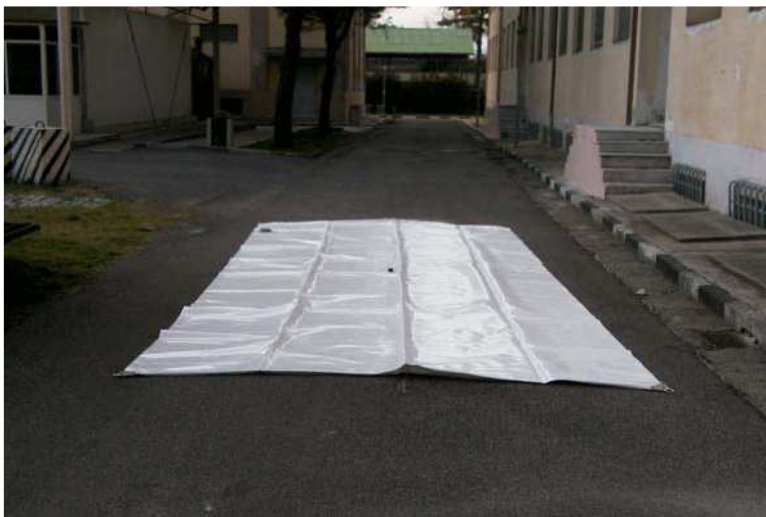
foto n. 16 - Serbatoio esterno acqua
