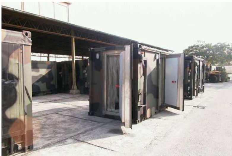
foto n.1-Vista d'insieme dello shelter frigo bicella
