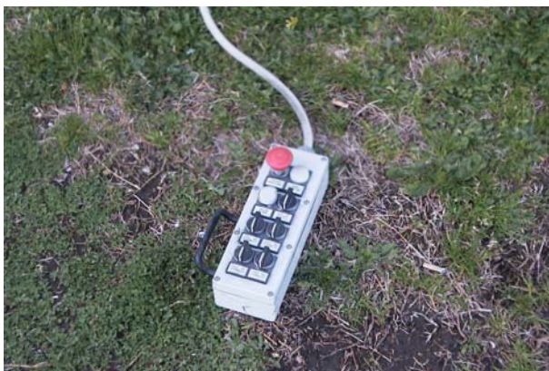
foto n. 11 - Pulsantiera di comando
