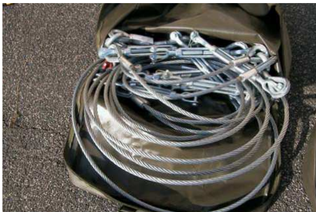
foto n. 15 - Funi di ancoraggio
