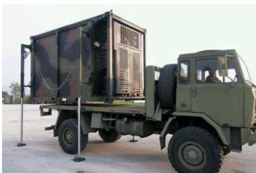
foto n. 10 – Impianto di sollevamento
