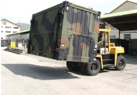
foto n.4-Sollevamento a mezzo carrello elevatore
