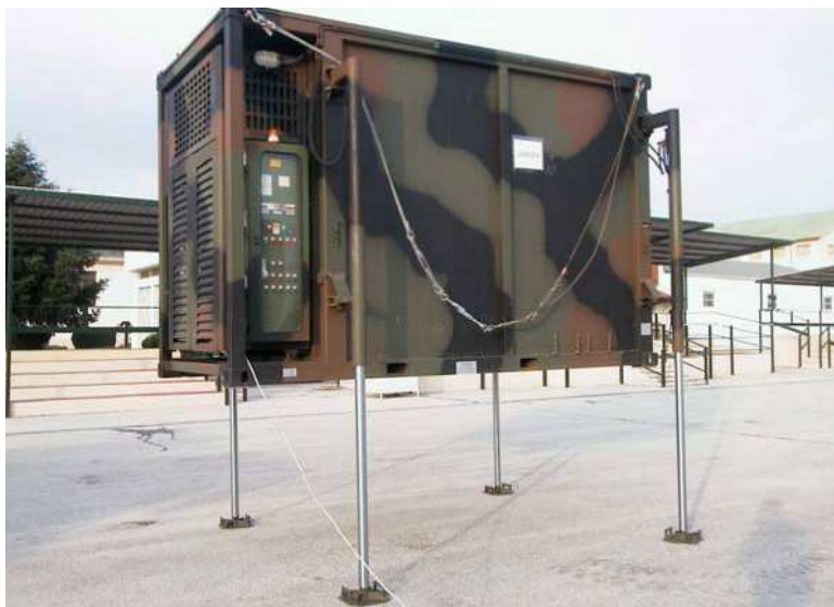
foto n. 10 – Impianto di sollevamento
