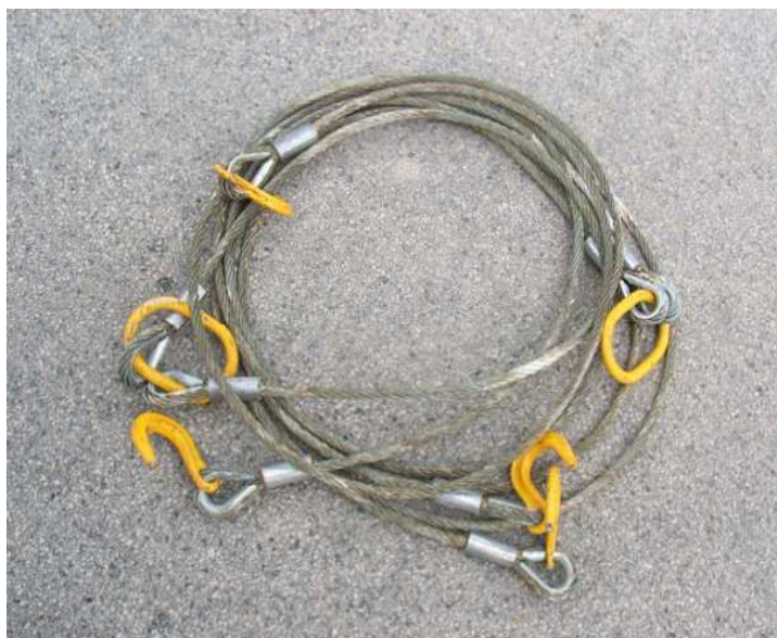
foto n. 15 - Funi di ancoraggio 290
