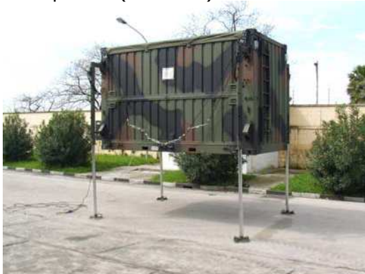
foto n. 1 – Dispositivo di autosollevamento
