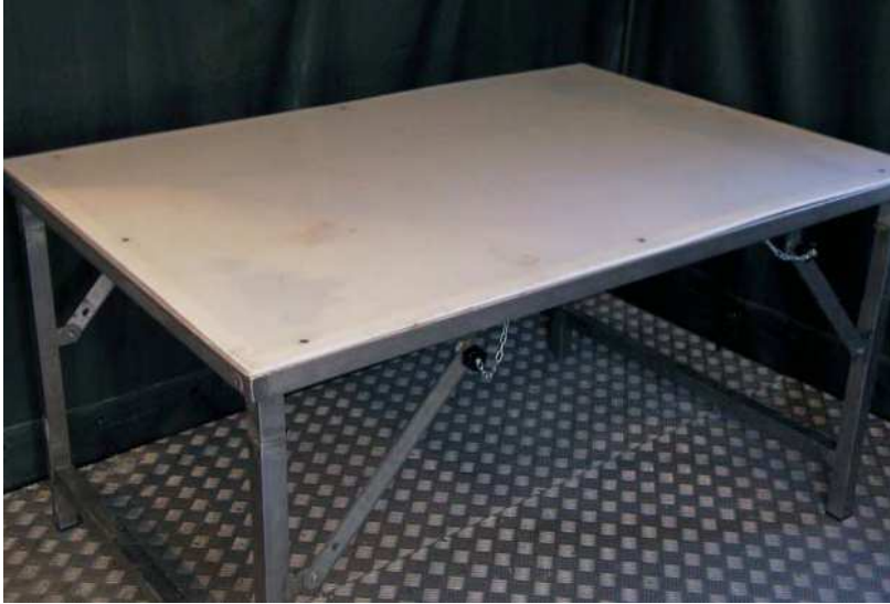
foto n. 12 - Banco da lavoro in acciaio inox
