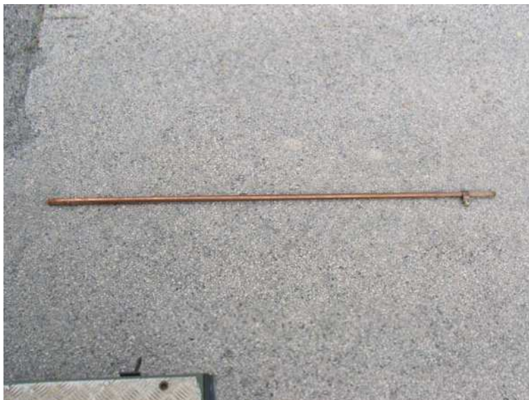
foto n. 12 - Dispensore di terra
