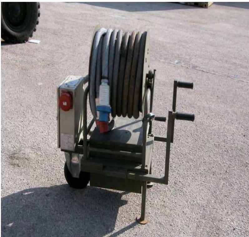
foto n. 24 - Carrello autotrasformatore con aspo e prolunga elettrica
