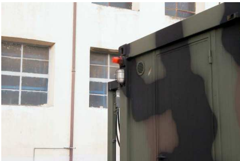
foto n. 4 – Lampada segnalazione scarramento
