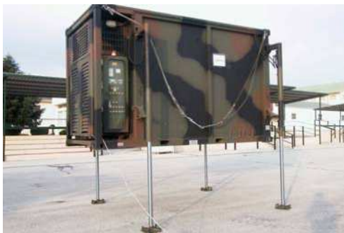
foto n. 9 – Impianto di sollevamento
