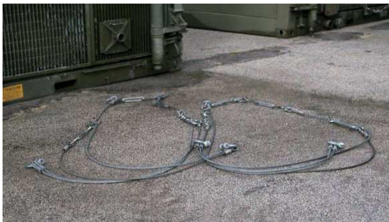
foto n. 21 - Funi di ancoraggio
