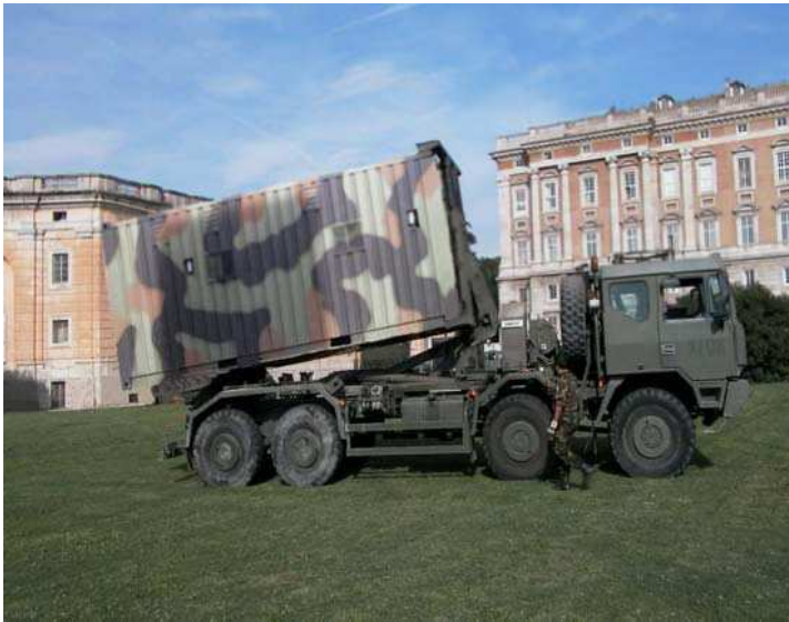
foto n. 1 – Scarramento shelter da APS
